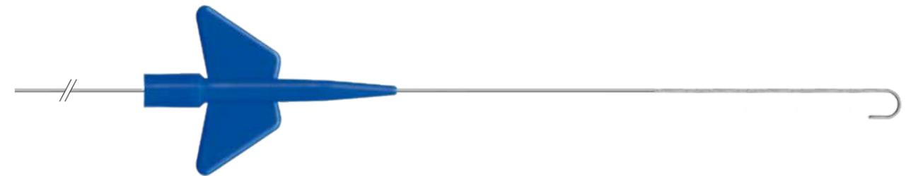
Проводник смены по Schueller, диаметр .035 дюймов, 90см длиной, гибкий кончик (10см), жесткий shaft (40см), гибкий конец, 3 мм J-изгиб
