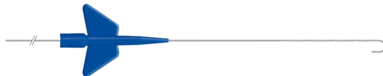
Проводник для смены по Schueller, диаметр .035 дюймов, 90см длиной, гибкий кончик (10см), жесткий shaft (40см), гибкий конец, 3 мм J-изгиб
